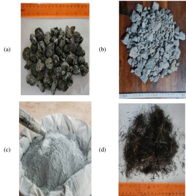
Fig. 1. Asphalt mix materials: (a) NS, (b) CS, (c) cement filler, and (d) palm fiber.
