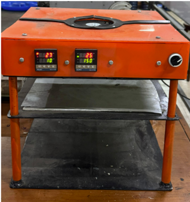
Fig. 1. Hot press machine.
