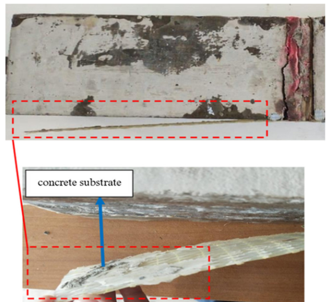
Fig. 8. CSG A failure mode.
