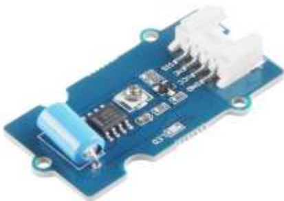
Fig:4 VIBRATION SENSOR
