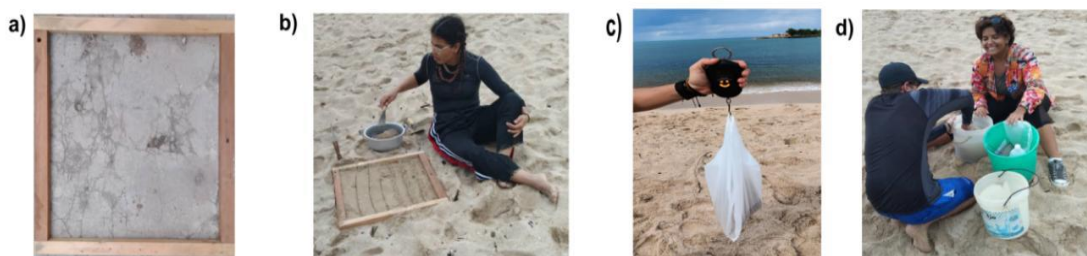
Figura 6.- Procedimiento del muestreo y objetos empleados. a) Cuadro de madera 50 x 50 cm. b) Toma de las muestras de arena. c) Pesa digital y muestras de arena siendo pesadas en las bolsas de nylon. d) Enjuague y filtrado de la arena.
