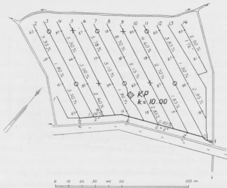
Kuva 6. Kartta eräästä v. 1874 toteutetusta tiiliputkiojituksen ojansyvyys- ja putoussuhdemerkintöineen.
