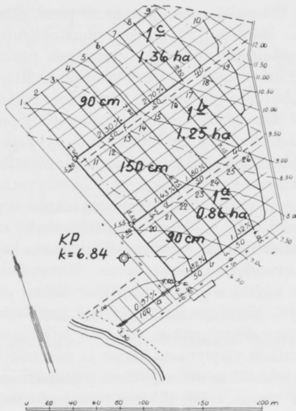
Kuva 7. Salaojituskoealue salaojen erilaisen syvyyden vaikutusten selvittelyä varten tiiviillä hiesu-savimaalla.
