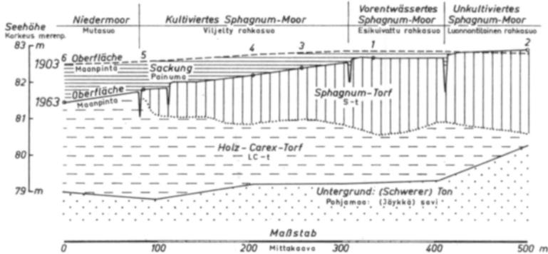
Abb. 3. Profilschnitt durch die Messpunkte 1 bis 6 in Leteensuo.
