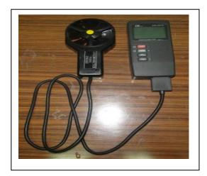
Fig. 9. Digital Anemometer.
