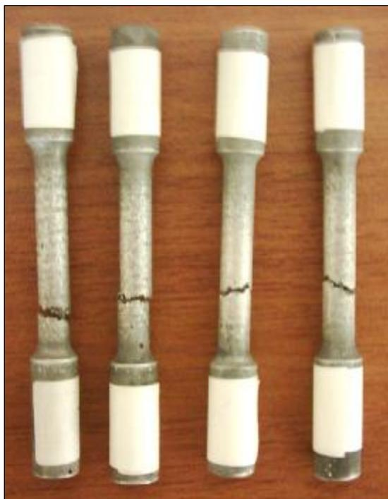
الشكل - ١- الصور الفوتوغرافية لعينات اختبار الشد بعد الفحص.
