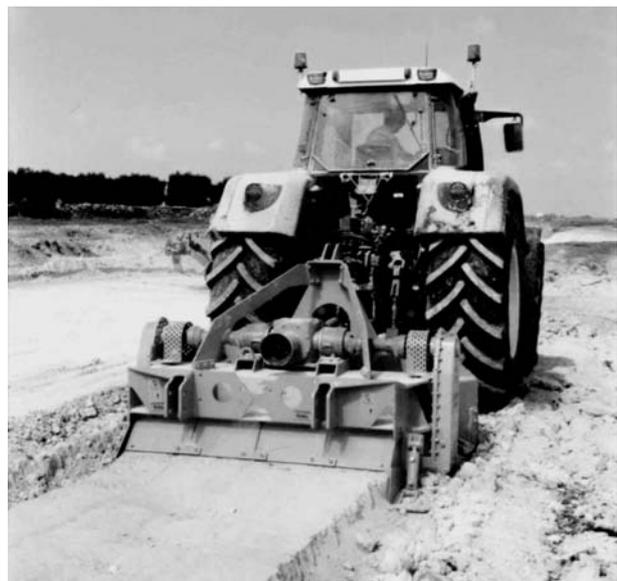
Fig. 4 - Operazioni di frangitura nelle Murge alte. Si noti la trasformazione dei blocchi calcarei frammisti a suolo in un aggregato finissimo polverulento.
