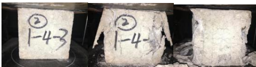
(d) Test piece with 0.2% basalt fiber
