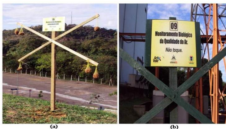
Figura 1. a) Modelo do suporte de um estação de medição *moss bag*; (b) Modelo de identificação padrão de todas as estações *moss bag*.
