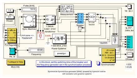
Fig. 7. The Simulink model.
