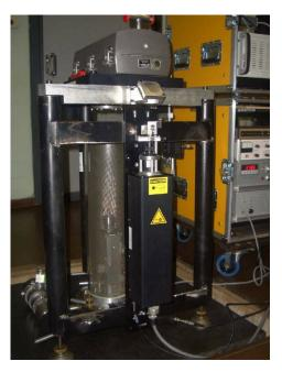
Figure 2: Absolute gravimeter IMGC-02.
