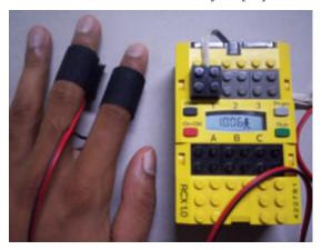
Fig. 4. LEGO GSR sensor unit.
