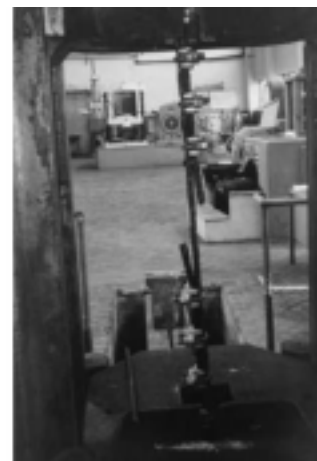
Tuercas del lado de la punta muerta del cable
