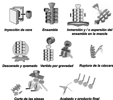
Figura 1. Proceso de microfundición. Fuente: http://www.hitc-hiner.com/home.html , http://www.kp.dlr.de/
