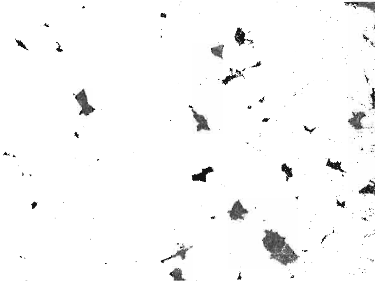
Rys. 3. Pęknięcia typu wnętrkowego (stal H23N18) — pełzanie w temperaturze 1123 K, naprężenie \sigma = 60 MPa, pow. 50X
