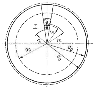
Rys. 4. Charakterystyczne wymiary powierzchni czołowej próbki: a_0 , r_0 — początkowe; a_a , r_a dla odkształcenia \epsilon_a = \epsilon_s - \Delta\epsilon/2 ; a_b , r_b dla odkształcenia \epsilon_b = \epsilon_s + \Delta\epsilon/2
