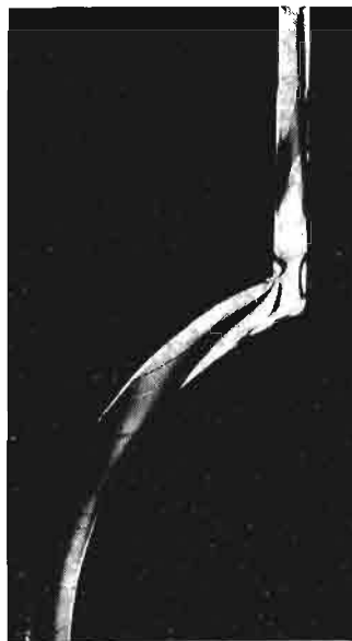
Rys. 13. Izochromy całkowite w płycie obwodowej walczaka z króćcem \varnothing 64/\varnothing 50
