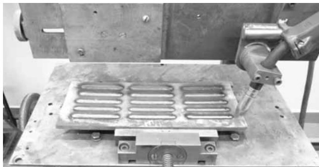
Rys. 3. Próbką z ułożonymi ściegami na stanowisku badawczym Fig. 3. The sample with welding sequence on the test stand
