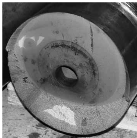
Rys. 3. Uszkodzona kolumna prasy hydraulicznej do wyciskania profili ze stopów aluminium, widoczne powierzchnie przełomu Fig. 3. Damaged column dismantled from hydraulic press for extruding profiles made from aluminium alloys. Two surfaces of the fracture are visible
