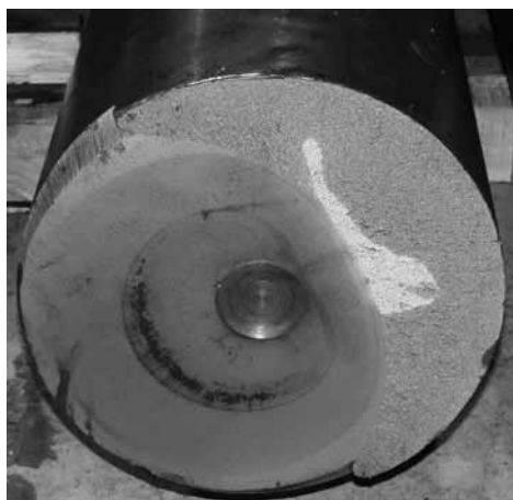
Rys. 3. Uszkodzona kolumna prasy hydraulicznej do wyciskania profili ze stopów aluminium, widoczne powierzchnie przełomu Fig. 3. Damaged column dismantled from hydraulic press for extruding profiles made from aluminium alloys. Two surfaces of the fracture are visible
