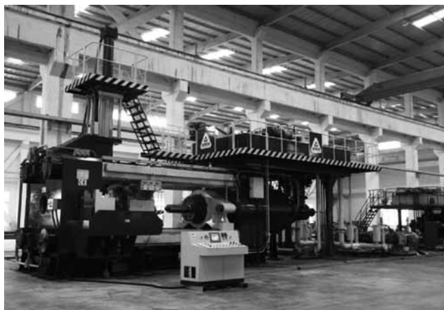
Rys. 1. Prasa hydrauliczna do wyciskania [3] Fig. 1. Hydraulic press for extrusion
