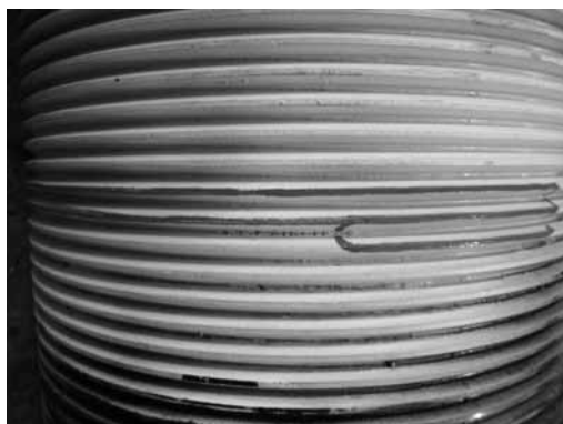
Rys. 4. Defektogram proszkowy uzyskany na wadliwej kolumnie prasy hydraulicznej, potwierdzający występowanie nieciągłości wykrytej metodą ultradźwiękową. Kolorem oznaczono wykryte wskazania Fig. 4. Magnetic particle indication of discontinuity in column from hydraulic press, as confirmation of indication discovered during ultrasonic testing. Indication has been marked.
