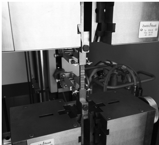
Rys. 3. Stanowisko testowe z próbką w uchwycie mocującym, z zamontowany ekstensometrem
