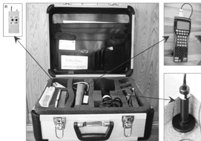
Rys. 3. Zestaw pomiarowy GP-5000 GalvaPulse™ [autorzy] Fig. 3. The GP-5000 GalvaPulse™ apparatus [authors]
