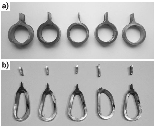
Rys. 6. Wyniki próby rozciągania złącza rura – płaskownik: a) próbki przygotowane do badania, b) próbki po zerwaniu Fig. 6. Results of tensile strength test for plate – tube welded joint: a) samples prepared for test, b) samples after rupture
