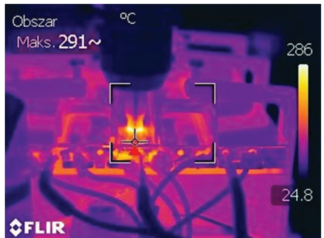
Rys. 13. Temperatura w początkowej fazie zgrzewania z podgrzewaniem Fig. 13. Temperature in the initial stage of welding with preheating
