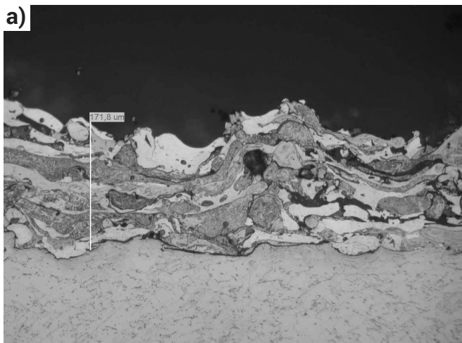
Rys. 2. Mikrostruktura powłoki natryskanej łukowo Fe-Al na podłoże stalowe z pomiarem grubości, a) x100, b) x200 Fig. 2. The microstructure of the Fe-Al sprayed coating on a steel substrate with a thickness measurement, a) x100, b) x200
