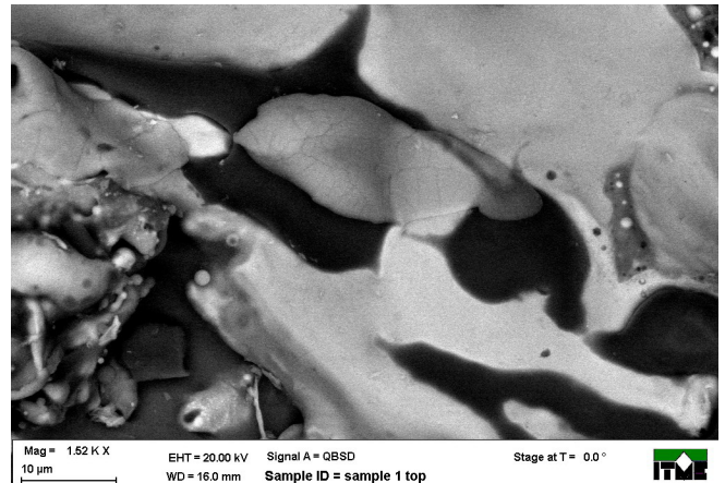
Rys. 9. Przykładowy obraz SEM powierzchni natryskanej powłoki Fig. 9. Sample SEM image of the surface of the sprayed coating
