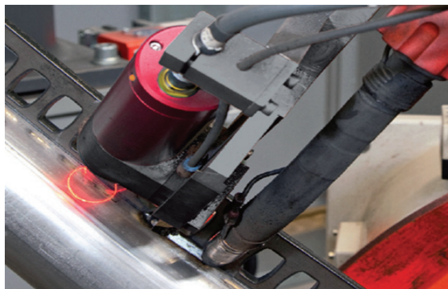
Rys. 13. Triangulacyjny laserowy system wizyjny z kołową wiązką skanującą [6]
