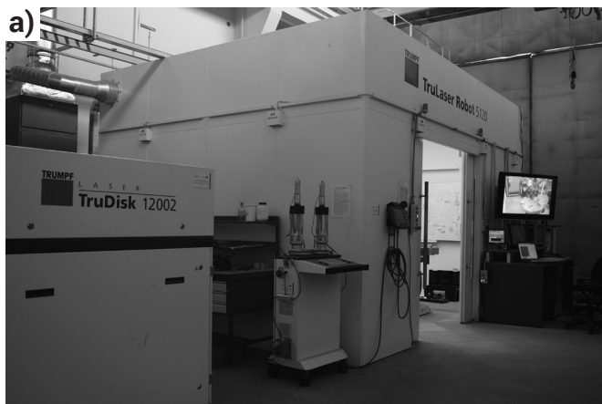
Rys. 2. a) Zrobotyzowane stanowisko do obróbki laserowej z laserem dyskowym TruDisk 12002 o max. mocy 12 kW (a), robot przemysłowy KUKA KR30HA z zamontowaną głowicą spawalniczą CFO stosowaną w badaniach (b)
