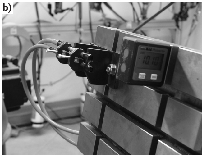
Rys. 3. Schemat procesu spawania elementów próbnych (a) w specjalistycznym przyrządzie ze zintegrowaną osłoną gazową (b) Fig. 3 Welding of the test elements (a) using the specialist device with the integrated gas shielding system (b)
