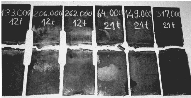
Rys. 2. Zniszczone próbki po badaniach zmęczeniowych Fig. 2. Damaged samples after fatigue tests
