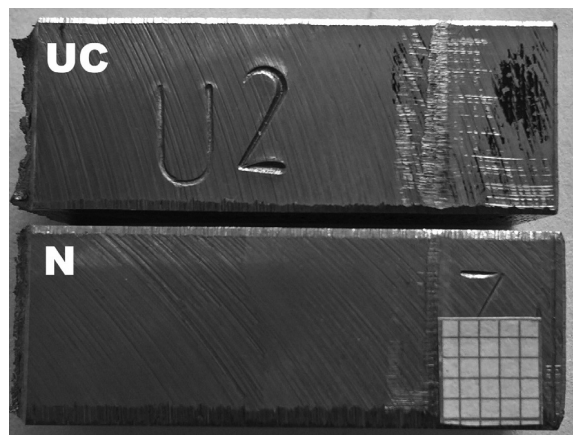
Rys. 9. Widok napoin Fig. 9. View of padding welds
