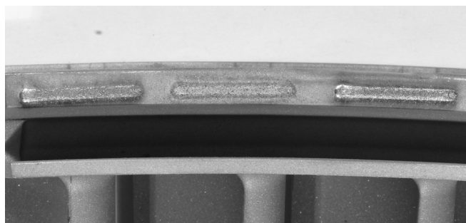
Rys. 1. Naprawa segmentu łopatek ze stopu Inconel 713C – napoiny wykonane laserem
