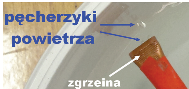
Rys. 3. Wynik próby szczelności złącza zgrzewanego ultradźwiękowo Fig. 3. Results of the tightness test of the ultrasonic welded joint
