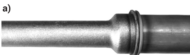
Rys. 2. Przykład elementu zgrzewanego tarcowo z pozostałą (a) i usuniętą wyływką (b) Fig. 2. Example of a friction welded element with (a) and without flash (b)
