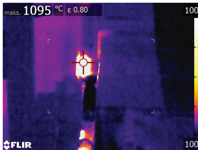
Rys. 9. Pomiar temperatury rozpoczęcia fazy 5 procesu zgrzewania tarcowego
