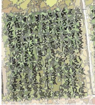
Figura 2. Imagen tomada sobre el lote de banano después del proceso de segmentación usando un parámetro de escala de 10, ponderaciones usadas para la heterogeneidad espectral de 0,8 y forma de 0,2; empleando el software eCognition®.
