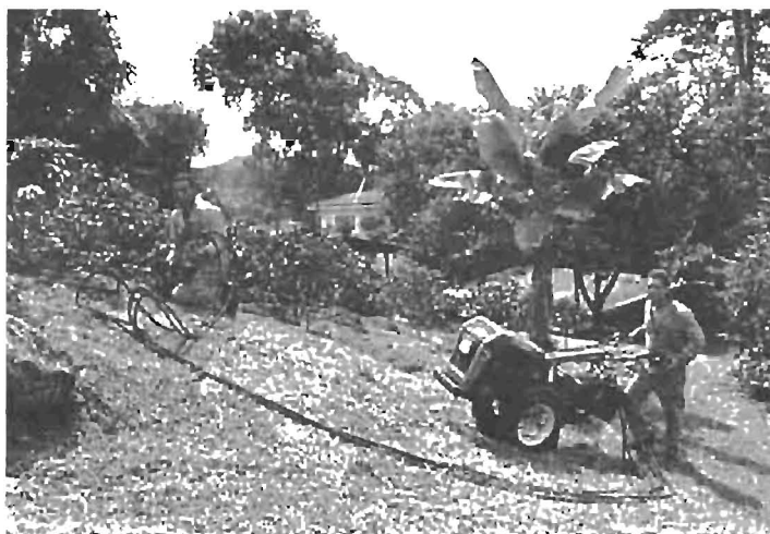
Figura 16. Prototipo de cosechador de café por vibración circular al tallo.
