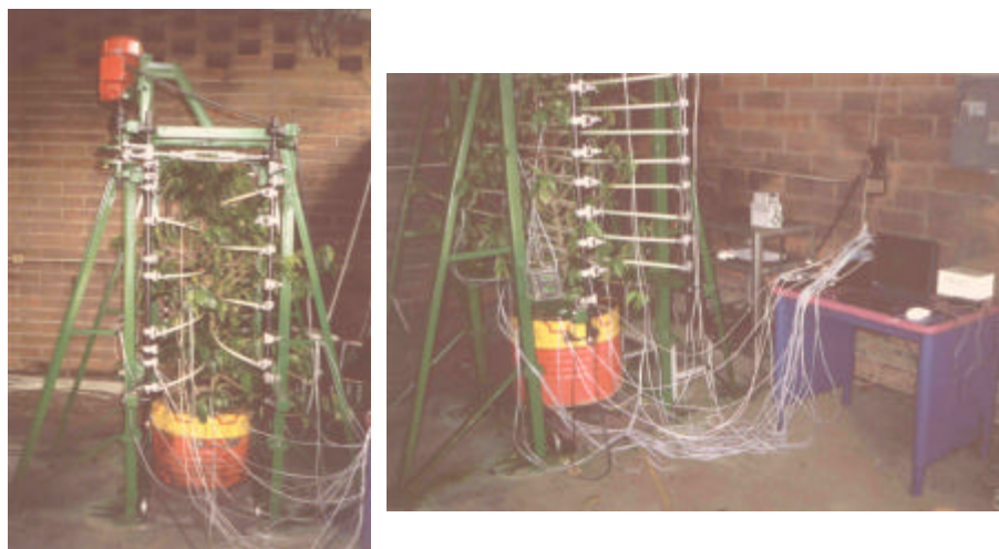
Figura 2. Prototipo para estudiar vibraciones laterales en múltiples puntos del café y equipos empleados para el registro de las vibraciones.
