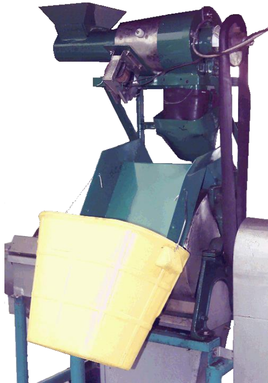
Figura 5. Prototipo del separador de objetos duros PESELOD III instalado al módulo para el beneficio de café BECOLSUB 300.
