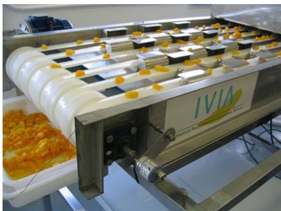
Figura 6. Máquina para la clasificación automática de gajos de mandarinas.
