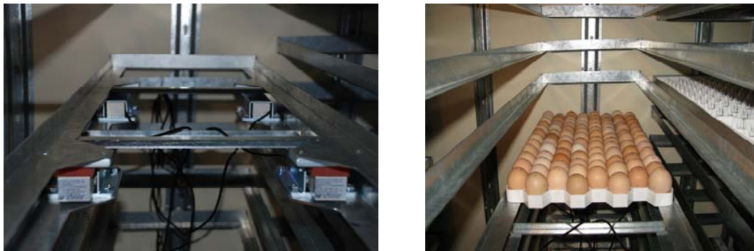
Figura 7. Sistema de medición de peso de huevos. (Cortesía: CASP S.A. Industria y Comercio).
