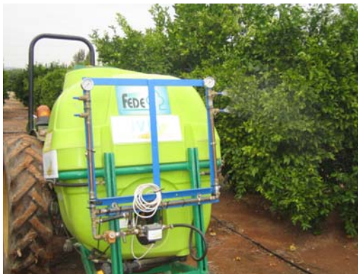
Figura 3. Máquina automática para realizar tratamientos de parcheo.
