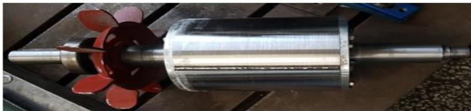
(d) Final assembled rotor after machining
